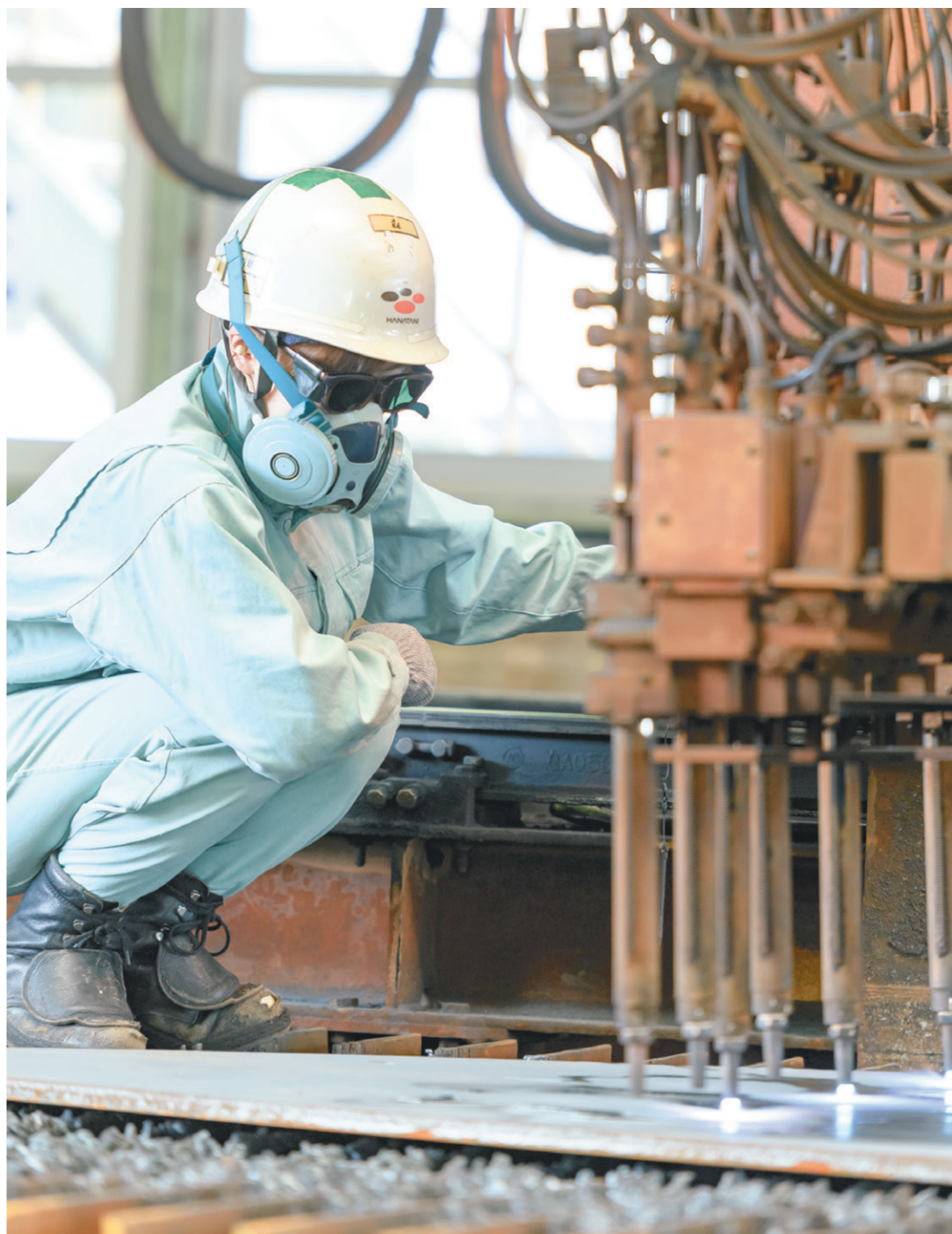
どんな形の部材、何個つくるのか。機械の動きをチェックしながら、大量の部材を切り出していく。
