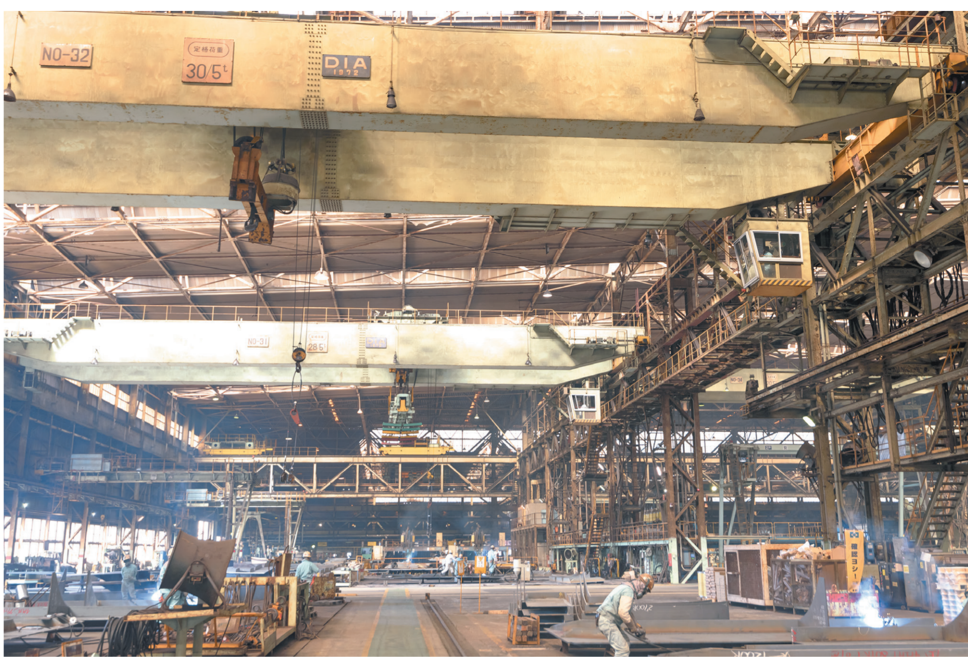
右上に見えるのが、木村さんが乗っているクレーン操縦室。工場全体を見渡しながら、細心の注意を払って巨大な鉄板などを吊り上げ、運んでいる。
